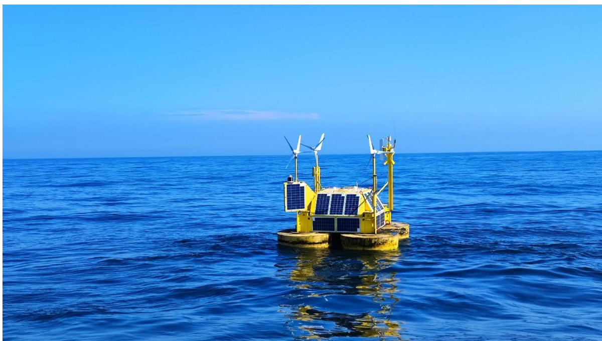
Figur 2. FLiDAR (Floating LiDAR) som kommer placeras ut inom vindparksområdet Galene för att mäta vindhastigheten på platsen svenska.
